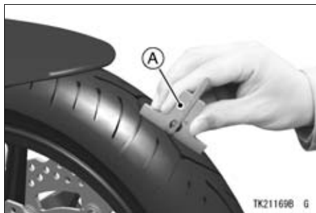
A. Galga de profundidad del dibujo de los neumáticos
